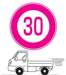
→ 時速30kmを超えて走行されると、チェーンが遠心力で膨らみ、車体と接触する恐れがあると共に耐久性を著しく低下させ、早期破損の原因となり車両事故等につながる恐れがあります。
