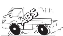
ABSは急ブレーキや滑りやすい路面でブレーキを踏んだ時にロックを防止し、制動力及び車体姿勢を維持する装置です。しかし、雪道などではチェーンの装着に関わらずABSの付いていない車に比べて制動距離が長くなることがありますので、特に車間距離や速度に余裕を保った走行を心がけてください。
