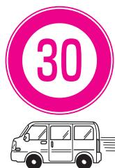
→ 時速30kmを超えて走行されると、チェーンが遠心力で膨らみ、車体と接触する恐れがあると共に耐久性を著しく低下させ、早期破損の原因となり車両事故等につながる恐れがあります。
