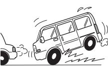
雪道では制動力が低下します。チェーンを装備していても車間距離は十分に保って走行してください。制動時にはエンジンブレーキを併用し、ペダル操作は慎重にポンピング（踏む→離す）を行ってください。FR車及び後輪にチェーンを装着する4WD車では前輪が大変滑りやすくなります。
