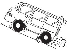
坂道での発進時は、もっとも空転しやすくなります。空転させると本来のチェーン性能が発揮されないばかりか、破損の原因となりますので、アクセルを踏みすぎないようゆっくり車を動かし、動きだしたら一定の速度で登坂させてください。
