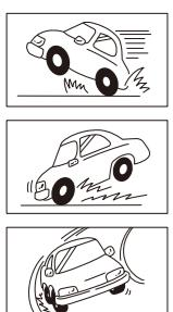
→やむをえずこのような運転操作を行った場合は、安全な場所に停止してチェーンの状態を確認して下さい。また、急な操作を行いますと車体への接触、異常摩耗等により早期破損の原因となり車両事故等につながる恐れがあります。
