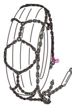
⑤テンションチェーン先のストッパーを、下側の赤色のアウターフックに接続します。(あらかじめストッパー側をロック部より引き出しておいて下さい。)
