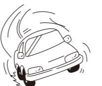
新雪やシャーベット状の路面又は凍結路面では引っ掛かりが少なく、タイヤチェーンのスパイク効果が薄れ、大変滑りやすくなります。低い速度で慎重に走行して下さい。
