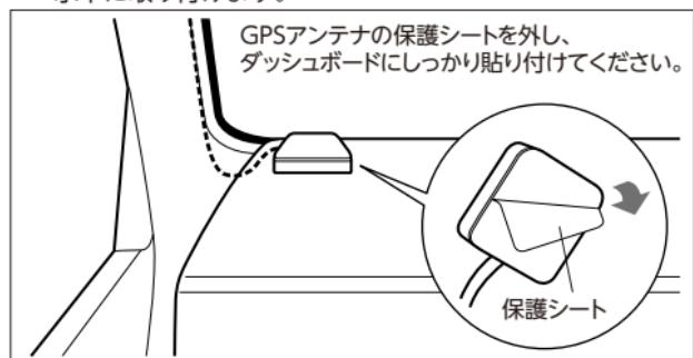
※テレビ／ラジオアンテナの近くに取り付けないでください。GPS電波の受信の妨げになったり、テレビ／ラジオの映像や音声の乱れの原因になります。
